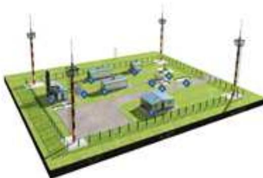
АГРС представляет строения моноблочного типа или из нескольких блоков, включающих в себя узлы заводской готовности.
